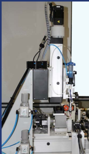
Lackiereinheit mit Vier-Achsen-Führung und volumetrischem Dosiersystem VDS-145
